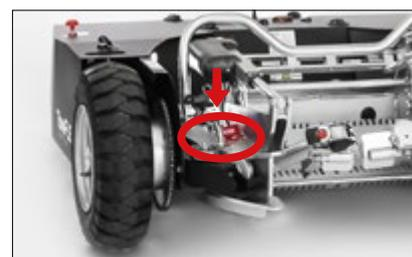
Bolzen zur Sicherung des Drehtellers
